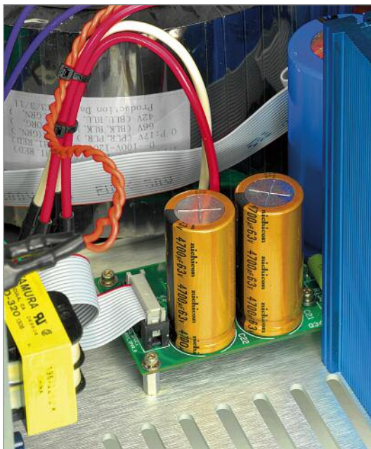
Links oben: Phonoplatine für MM und MC mit Dipschaltern zur Anpassung des Eingangswiderstands Rechts oben: Platine mit USB-Schnittstelle für den D/A-Wandler Unten: Machtzentrale: Geschirmter 1500 VA Ringkerntrafo und Elkos mit hoher Siebkapazität
